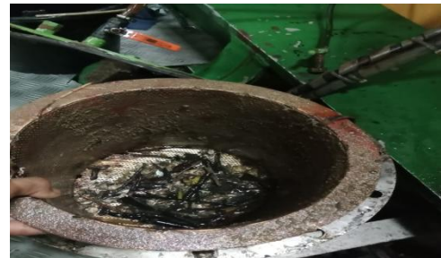
Gambar 2 Saringan air laut (Sea Chest) yang tersumbat pasir dan lumut
